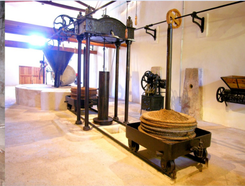
Restauració de la premsa, la bomba hidràulica i les vagonetes
