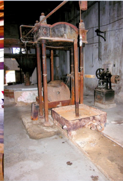
Restauració de la premsa, la bomba hidràulica i les vagonetes
