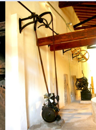
Restauració del motor de combustió i reconstrucció de l'embarrat
